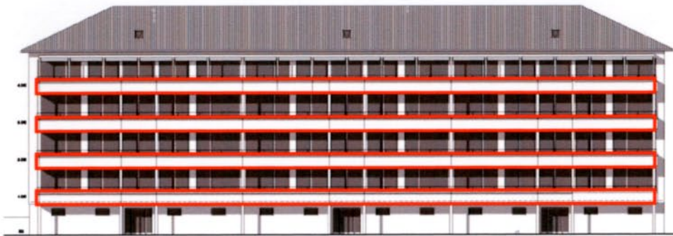
Balkonbrüstungen Auswasch-Malerei in Beton
